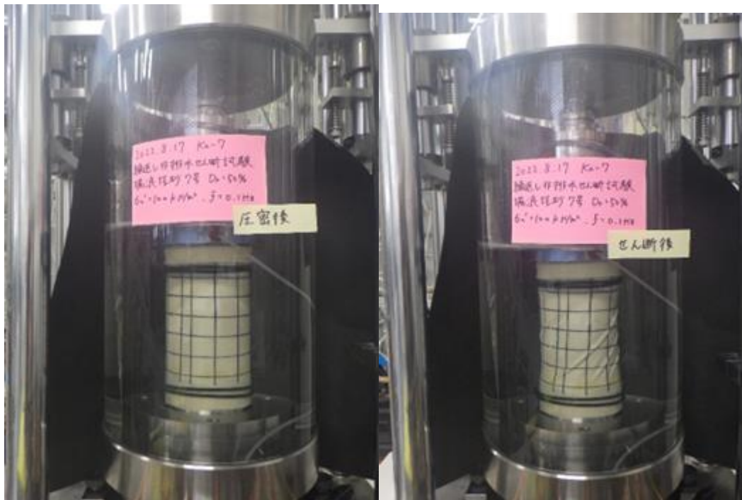
図4.7.26 リブ無しトップキャップを使用した繰返し载荷試験時の供試体の様子 (左側：圧密終了後载荷前の状況 右側：繰返し载荷終了後の供試体の様子) リブが無くてもトップキャップと供試体に乖離は無く、滑る等の様子は見られない。
