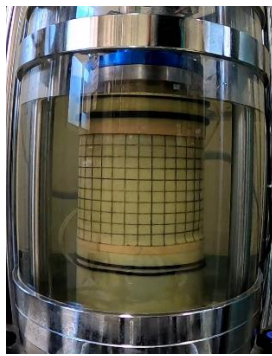
(b-1) 50P-Q-1 (軸力一定・試験前)
