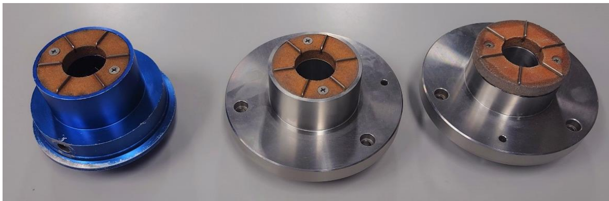
図4.7.1 上部トップキャップ（左）および下部ペDESTAL（右2つ）に設置されるリブ付き中空ねじりせん断試験用ポーラスストーンの一例
