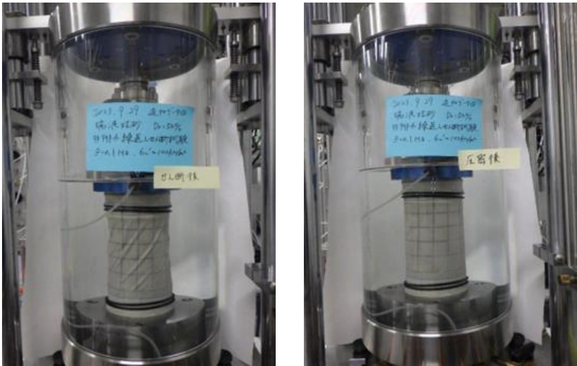
図4.7.26 リブ無しトップキャップを使用した繰返し载荷試験時の供試体の様子 (左側：圧密終了後载荷前の状況 右側：繰返し载荷終了後の供試体の様子) リブが無くてもトップキャップと供試体に乖離は無く、滑る等の様子は見られない。
