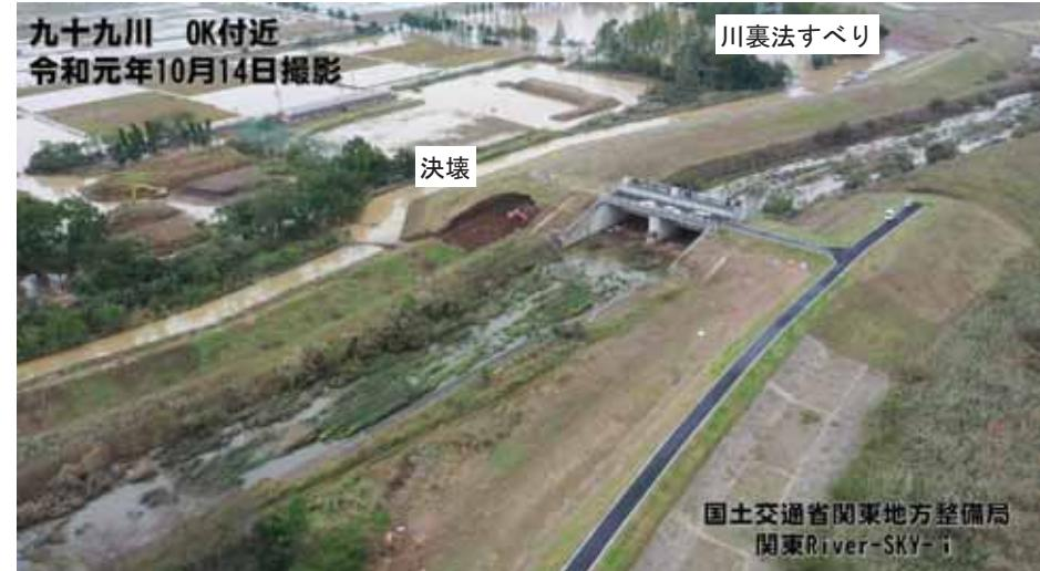
写真①：越辺川左岸7.6k（九十九川水門）-堤防決壊・応急復旧状況
