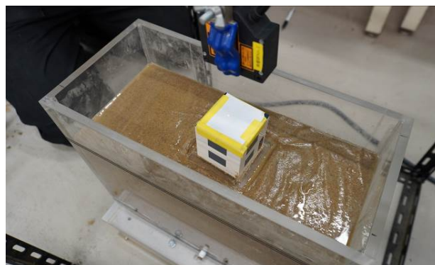
写真-2 住宅加振の様子
