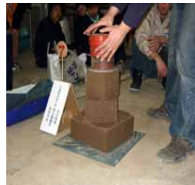
写真-4 ソイルタワーへの載荷
