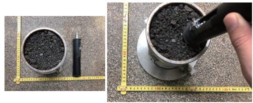
締固めしたスコリアの山中式土壤硬度計による強度測定
