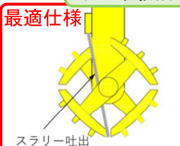
b) 攪拌翼軸前方噴射 最適な噴射仕様の検討
