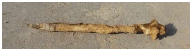
写真2 掘り起こしたミニアンカーPI
