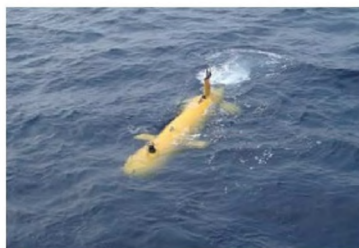
◀AUV(自律型無人潜水機)で海底近くまで潜り測定
