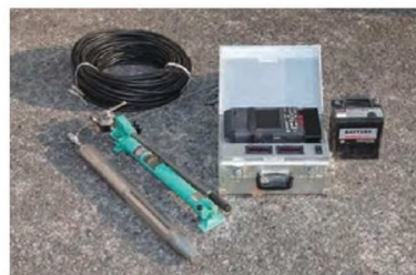
▲地盤の変形特性を求めるKKT試験機
