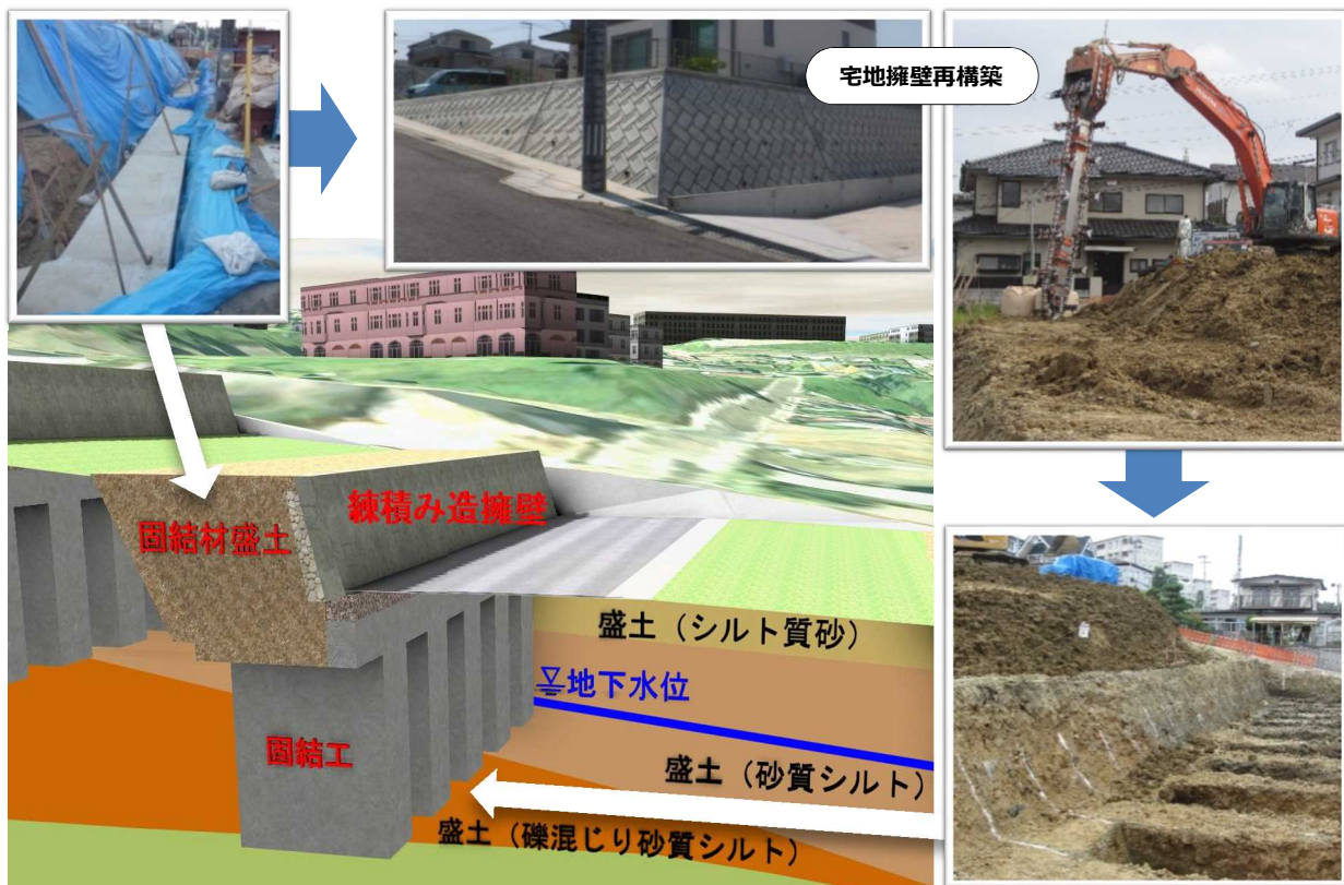
被災事例①の復旧及び再度災害防止対策：「固化材盛土+固結工」及び宅地擁壁再構築（練積み造り擁壁）
