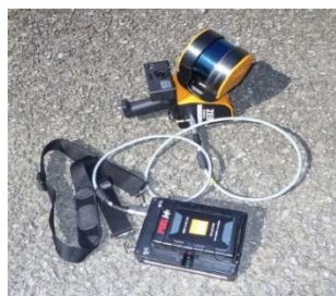
図-1 ハンディ型レーザースキャナ GeoSLAM ZEB HORIZON
