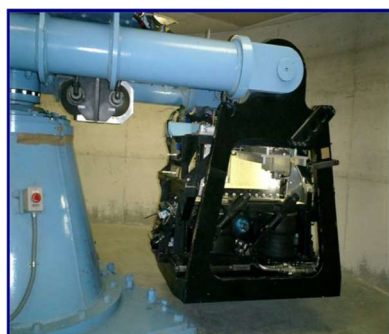
写真1 遠心振動台実験装置
