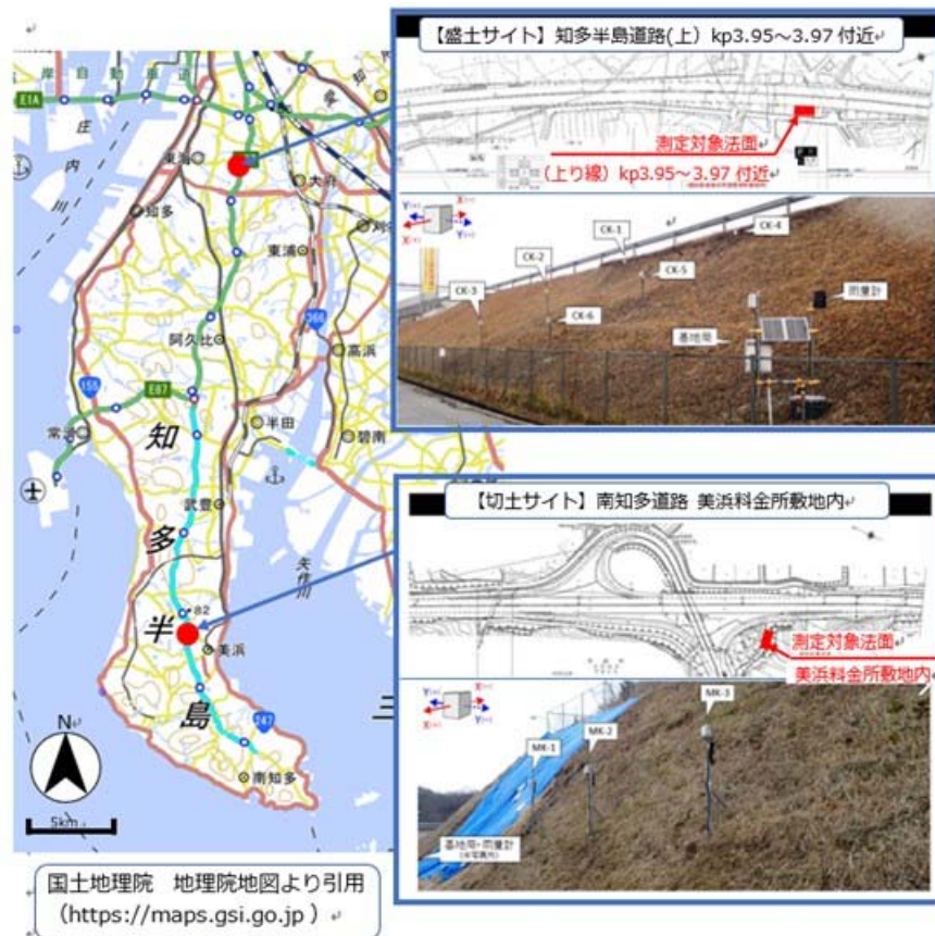
図2 実証サイトおよび現場モニタリングの実施状況
