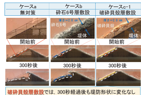
裏法面敷設材料別の侵食抑制効果確認実験の結果
