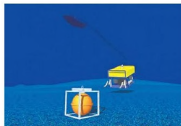
◀海底重力計とROV測定
