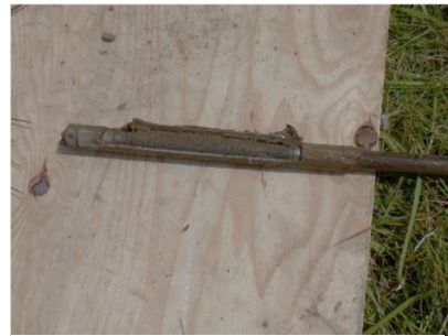
写真3 開閉式サンプラーで採取した土の試料
