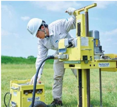
写真 7.1 SWS、SDS 試験（全自動機）
