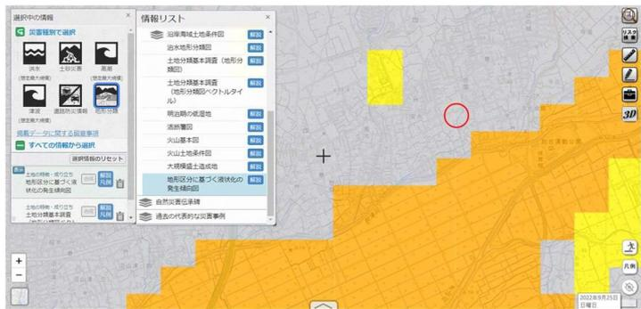
図 5.3 地形区分に基づく液状化の発生傾向図<sup>3)</sup>
