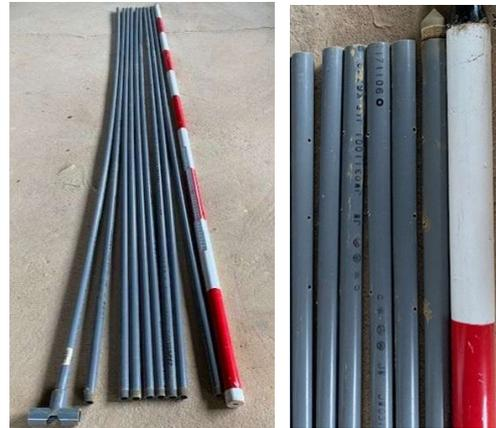
写真 7.3 中空有孔塩ビ管の例 (VP13 をねじ切り加工、φ3 mm穴加工)
