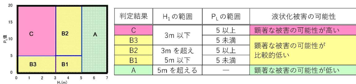
図 8.4 宅地の液状化被害の可能性判定図 ( $H_l$ - $P_L$  判定図)
