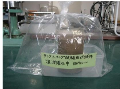
(b) 脱型後封緘養生中の改質土
