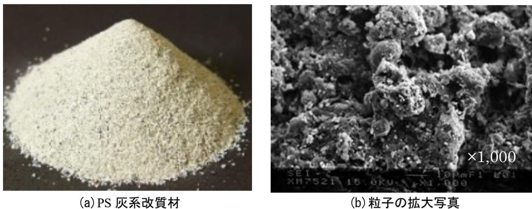
図 1.1 PS 灰系改質材の全景写真と拡大顕微鏡写真
