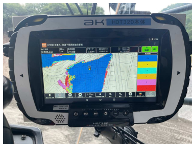
写真 3 TS・GNSS を用いた盛土管理
