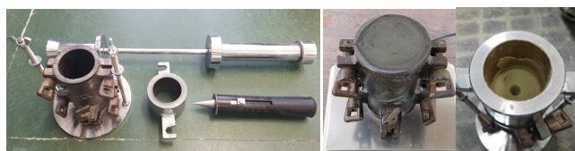
図-2 小型モールド法の試験器具と実施状況
