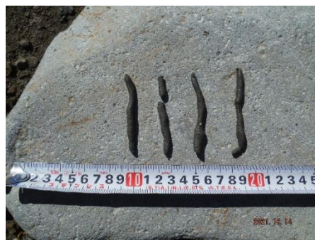
(c) 指頭法による貯水池底泥土用改質土の土性確認
