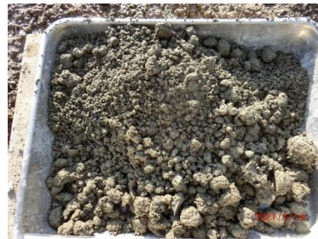
(b) 実機処理土（ため池底泥土木用改質土）
