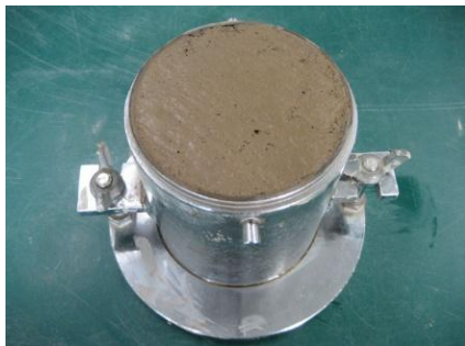
(a) 突固めて作製した改質土
