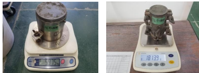
図 5.30 JIS 法 (1.0L モールド : 左) と簡易法 (0.2L モールド : 右)
