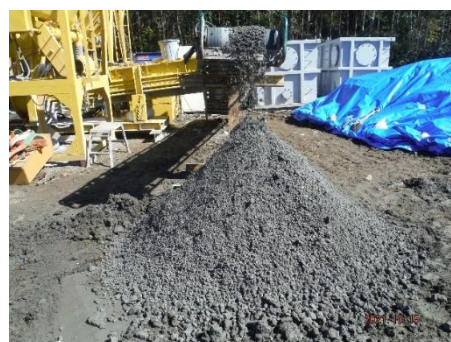
(b) 実機処理土（貯水池底泥土木用改質土）
