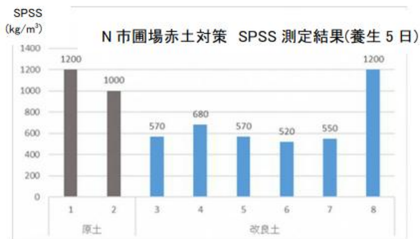
図 6.3 簡易 SPSS の測定結果
