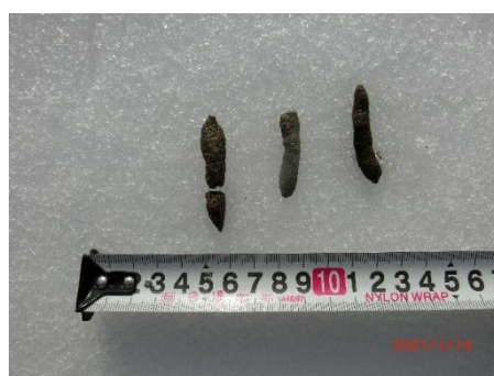
(c) 指頭法によるため池底泥土壌用改質土の土性確認
