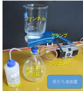
(b) 組み立てた吸引ろ過装置
