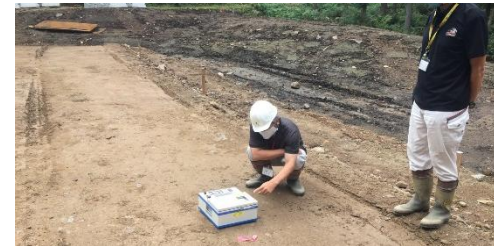
(f) RI 計器による締固め管理
