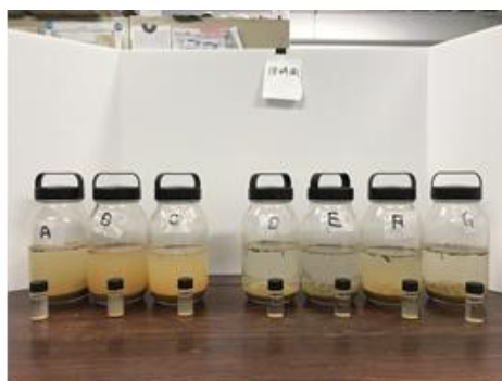
写真 6.7 濁度試験状況 (18 時間後)
