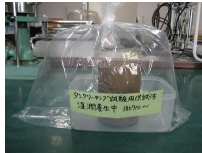
(b) 脱型後封緘養生中の改質土
