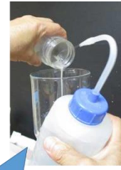
(c) 改質材のファンネルへの投入
