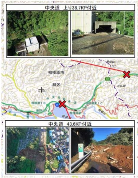
高尾～相模湖間(上り線) 土砂流入およびコンクリート壁崩落 ※神奈川県相模原市緑区付近
