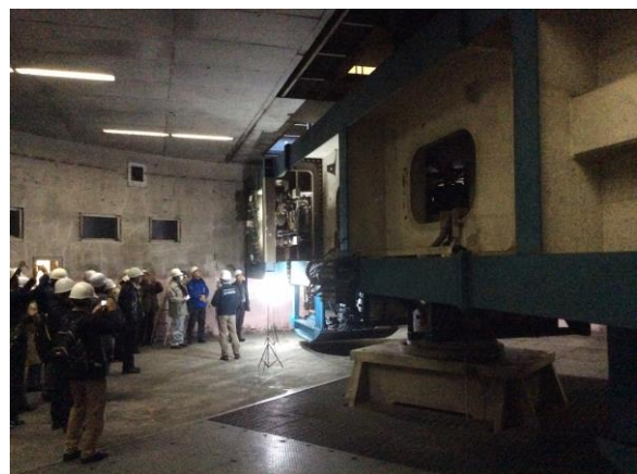
大型遠心力载荷試験装置
