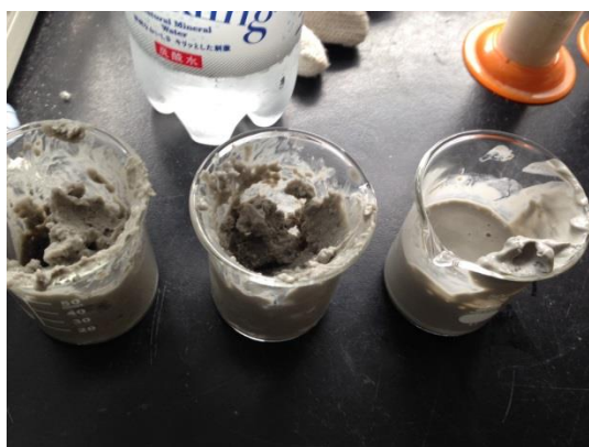
写真-1 ベントナイトと溶液の反応の様子(事前実験) (左から順に、蒸留水、炭酸水、食塩水、サラダ油、吸水性ポリマー)
