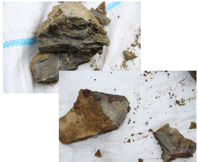
写真-10 トンネル切羽から採取された泥岩(上)と砂岩(下)
